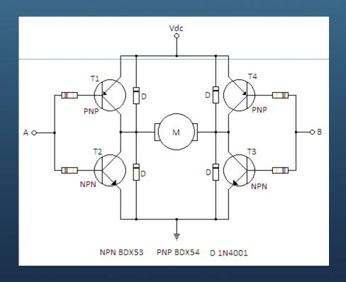
Il segnale di ingresso viene applicato al **pinA** e al **pinB** del ponte H. Quando A è alto e B è basso vanno in conduzione i transistor **T4** e **T2** provocando la rotazione a sinistra del motore
