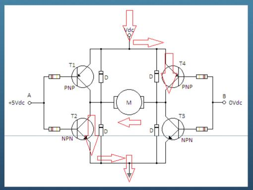
I transistors che ho usato in questo schema riescono a "sopportare", se correttamente raffreddati, circa 8A ed una tensione di lavoro massima di 45 Vdc.
